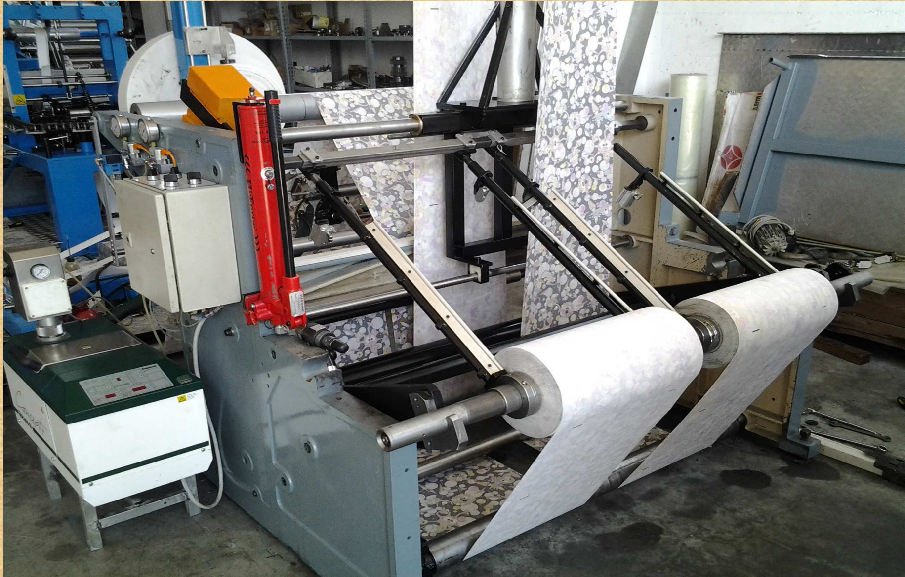
Svolgitore per Una e/o DUE BOBINE Prestampate / Unwinder for One and/or TWO pre-printed ROLLS. Fig.2/2.
